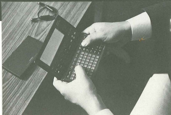
◆DK-5000(右)とDK-2000(左)をケーブルで接続し、データを転送。バックアップには万全を期している。
